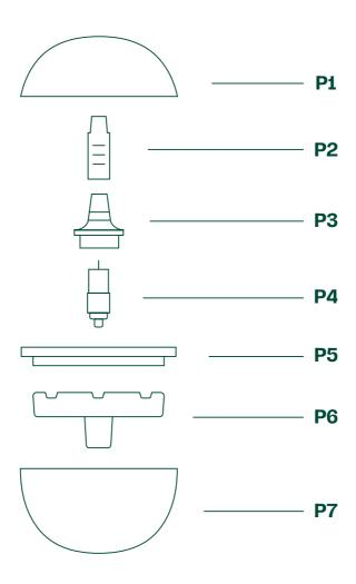
P1 LIGHT HAT P2 HEIGHT BLOCK P3 LOCK UNIT P4 WATER PUMP P5 PLANT TRAY P6 WATER TRAY P7 WATER BOWL
