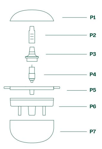
P1 LIGHT HAT P2 HEIGHT BLOCK P3 LOCK UNIT P4 WATER PUMP P5 PLANT TRAY P6 WATER TRAY P7 WATER BOWL
